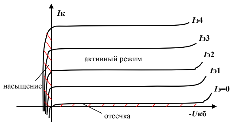
выходные ВАХ p - n - p -транзистора с ОБ
