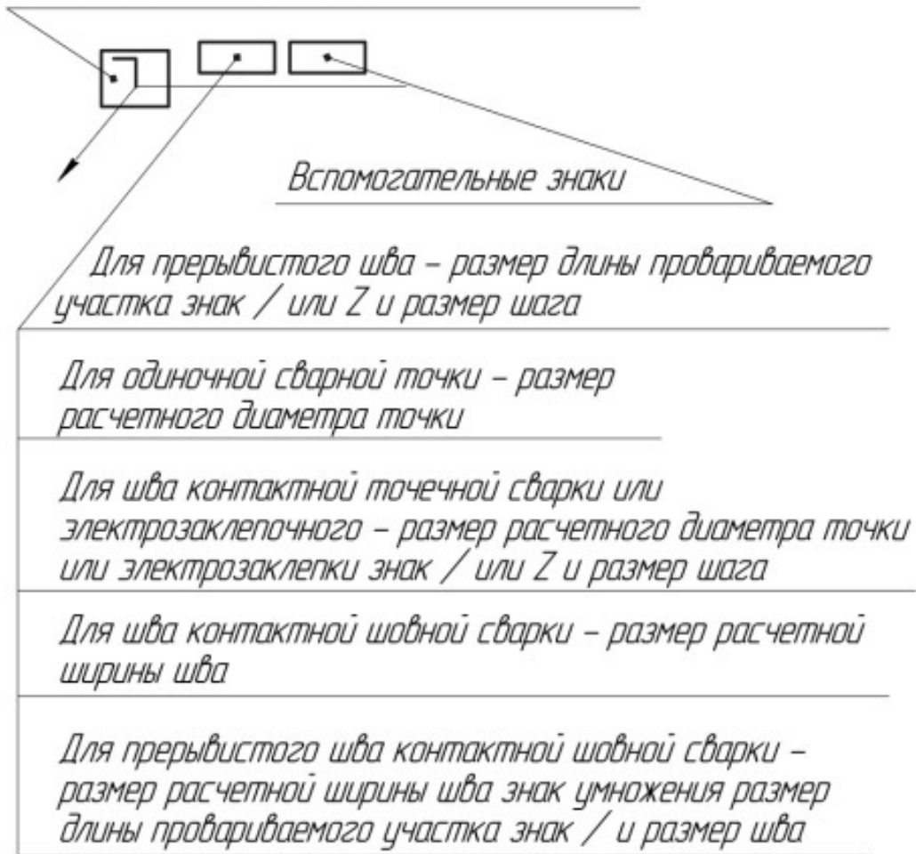
Рис. 38. Структура условного обозначения нестандартного шва одиночной сварной точки
