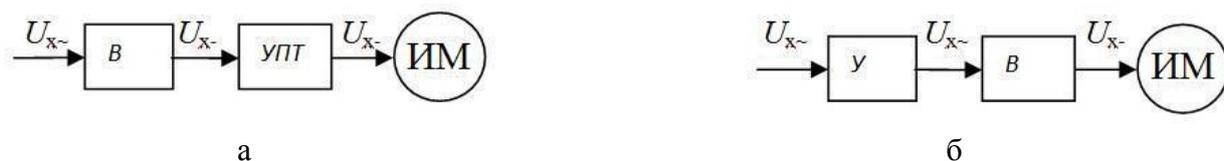
Рис.8 Структурные схемы вольтметров переменного тока:
