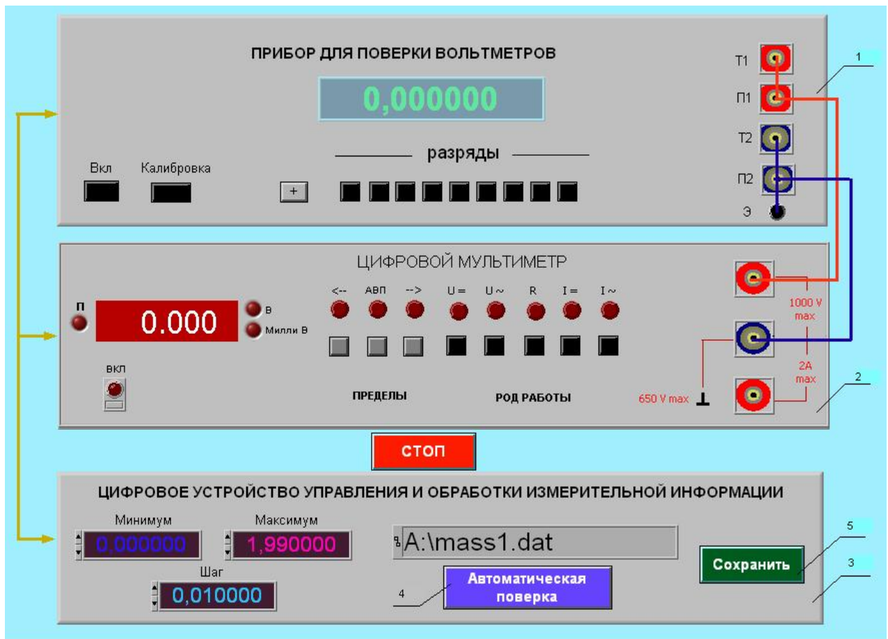
Рисунок 2.1.1 - Вид модели лабораторного стенда на рабочем столе компьютера (1-прибор для поверки вольтметров, 2-электронный цифровой мультиметр, 3-устройство управления, 4-кнопка запуска режима автоматической поверки, 5-кнопка запуска режима сохранения экспериментальных данных).
