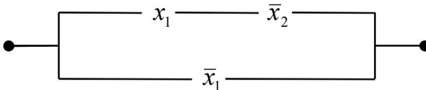
Схема проводит ток при  $x_1 = 1, x_2 = 0$ , а также при  $x_1 = 0$  и любом значении  $x_2$ .
