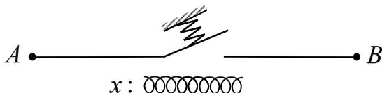
Если в катушке тока нет ( $x = 0$ ), то пружина оттягивает контакт, и проводник  $AB$  ток не проводит. Если  $x = 1$ , в катушке есть ток, то контакт притягивается, и проводник  $AB$  проводит ток. Для простоты такой контакт будем обозначать:
