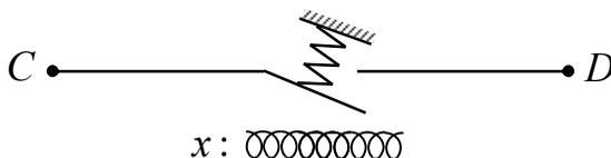
Ясно, что при  $x = 1$   $CD$  ток не проводит, а при  $x = 0$  контакт замкнут, и  $CD$  проводит ток. Размыкающий контакт реле будем обозначать так:
