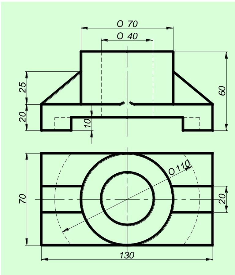
Построить 3D- модель детали с разрезом  $\frac{1}{4}$  детали, с выполнением штриховки.
